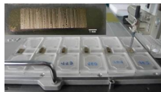
Bild 2: SPR-Chips im Nano Plotter bei der Mikroarrayherstellung. Oben links: Rückstände nach der Immobilisierung.
